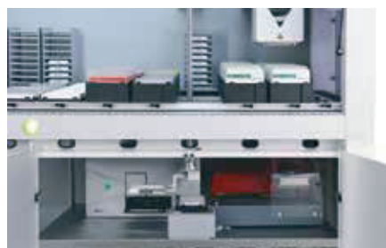
台面下方整合酶标仪和洗板机
