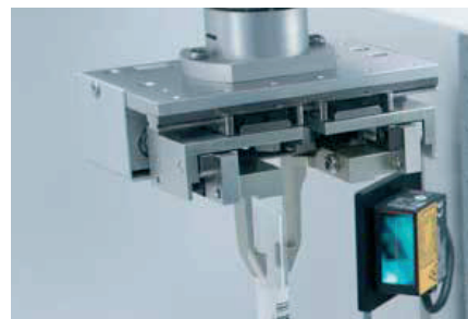
使用机械抓手臂处理试管
