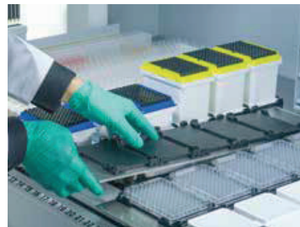
可更换的台面，实现灵活的设置、布局和设备集成
