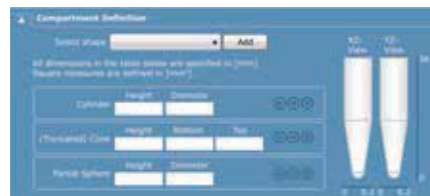
精细的实验器皿规格定义，帮助将探测到的液面高度转换为准确的液体体积信息
