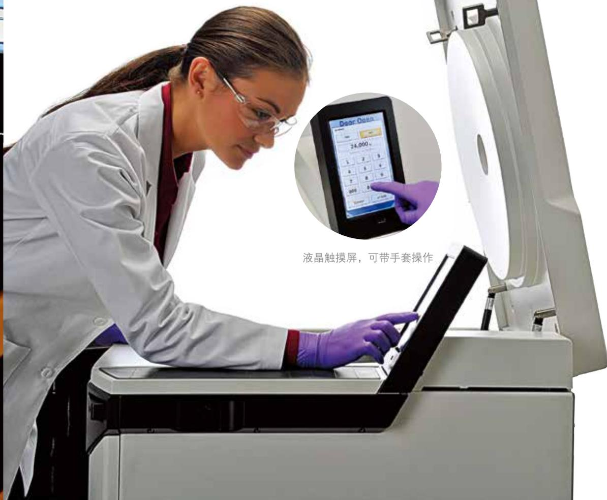
液晶触摸屏，可带手套操作
