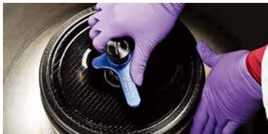
创新的速旋转头盖手柄，使得转头盖拧紧更方便，也便于（离心实验结束之后）开启转头盖取出样品
